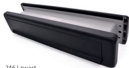
246 | zwart Complete brievenbus B 340 x H 74 mm Freesmaat B 323 x H 43 mm
