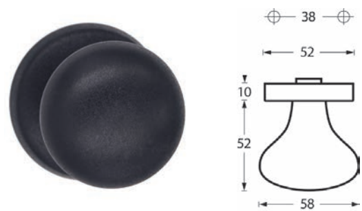
502-21 / vast Hartafstand: 38 mm Ø rozet: 52 mm Ø 58 mm alleen bij vleugeloverdekkend paneel mogelijk! (montage op paneel)
